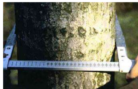
Fig. 43 Cavalletto dendrometrico utilizzato per la misurazione dei diametri
