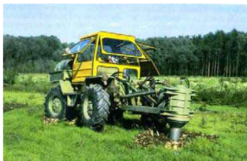
Fig. 41 Tritaceppi utilizzato per la frantumazione delle ceppaie
