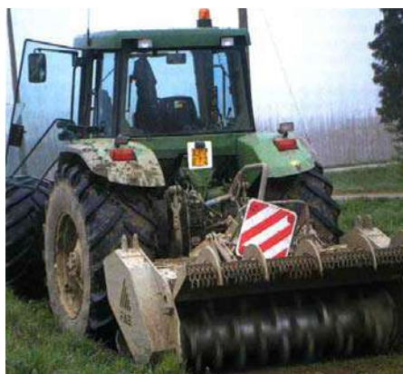
Fig. 39 Trituratore forstale utilizzato per l'eliminazione dei residui dell'abbattimento
