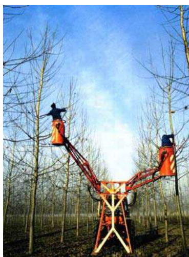
Fig. 26 Tagli di formazione e di pulizia del fusto eseguiti con l'impiego di cestelli elevatori
