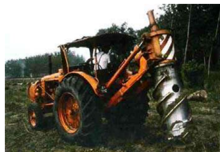
Fig. 40 Levaceppi utilizzato per l'estrazione delle ceppaie
