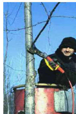
Fig. 22 Taglio di un ramo eseguito con forbici idrauliche rasente al fusto
