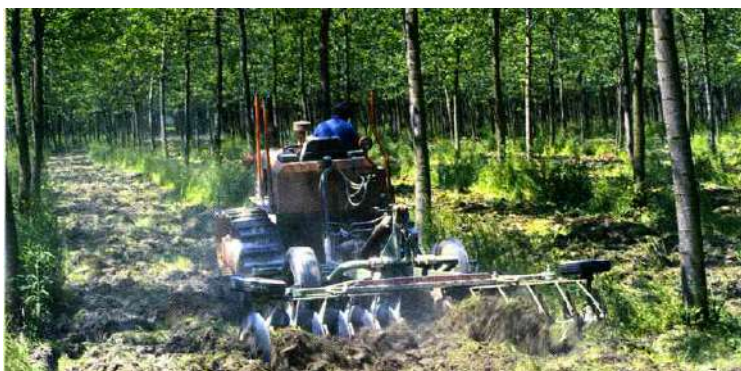
Fig. 14 Lavorazione del suolo con erpice a dischi
