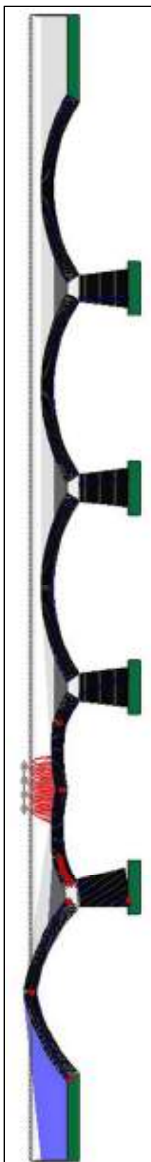
Figura 4.17 – Vista complessiva del ponte durante il cinematismo di collasso, posizione 8, \lambda = 7,31244
